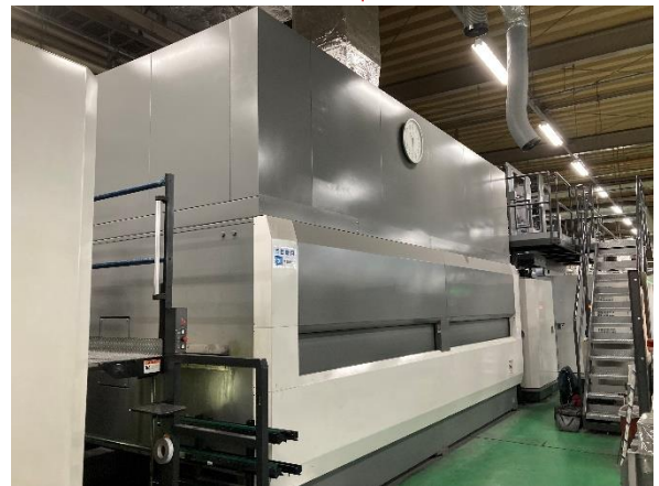
乾燥部（高熱のガスで強制乾燥を行う）
